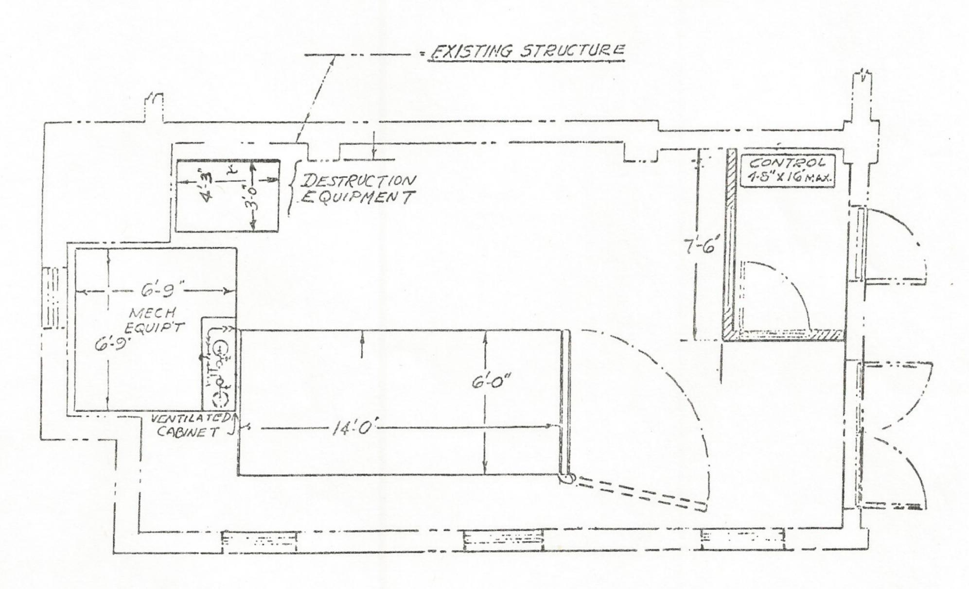
FREEZER DRYER/FUMIGATOR EQUIPMENT LAYOUT
